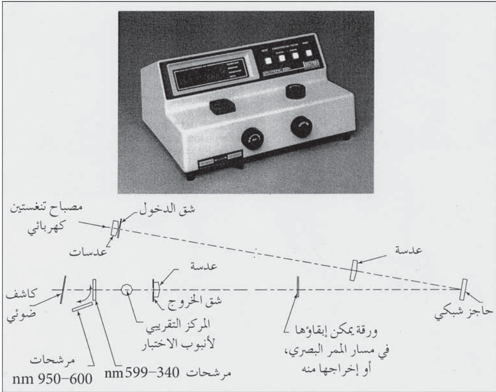
شكل 11-2: مقياس الطيف اللوني ومخطط النظام البصري (موافقة Milton Roy Company, Rochester, NY, a subsidiary of Sundstrand Corporation)
